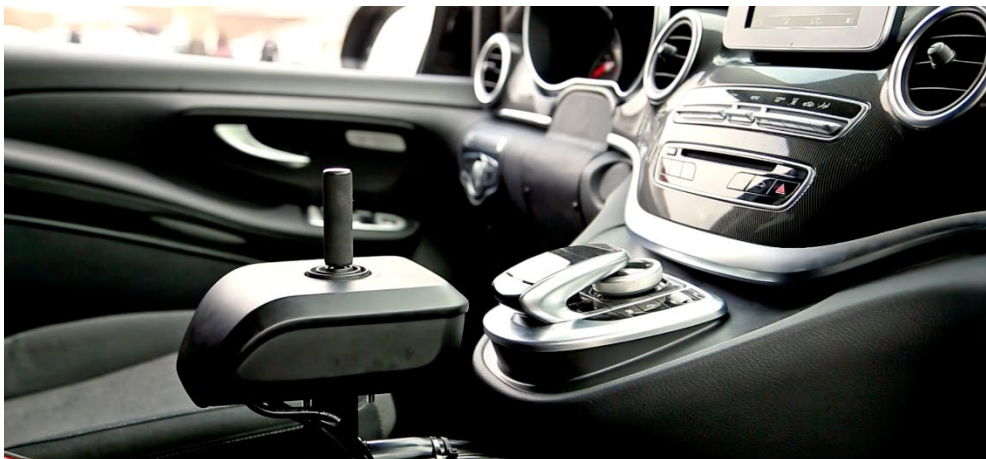
Space Drive: Schlüsseltechnologie für das autonome Fahren in Level 4 und 5 Foto: Schaeffler-Paravan
